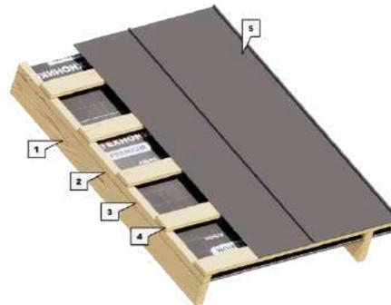
1. Фермы на МЭП заводского изготовления
