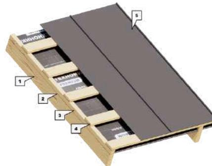
1. Фермы на МЭП заводского изготовления
